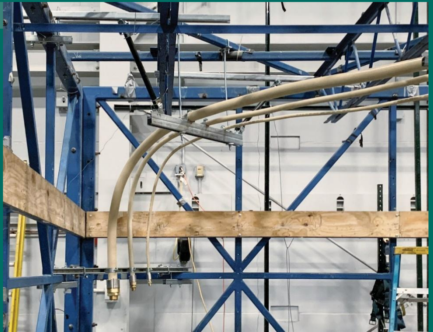
Das MediTrac® CMT-System auf dem seismischen Prüfstand
